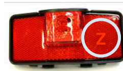
Schlussleuchte mit Großflächenrückstrahler „Z“
